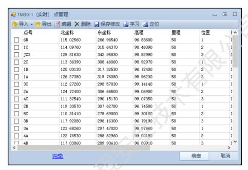
若未知监测点的初始坐标值,还可现场进行学习。勾选点号,然后现场人工照准目标,软件界面上点击学习,此时程序会控制全站仪进行测量,获取初始坐标值。
