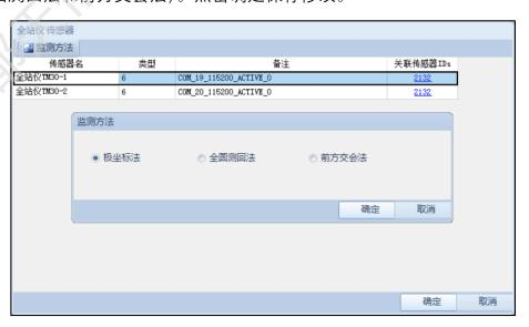
极坐标法:全站仪使用盘左测量,得到监测点的坐标值。
